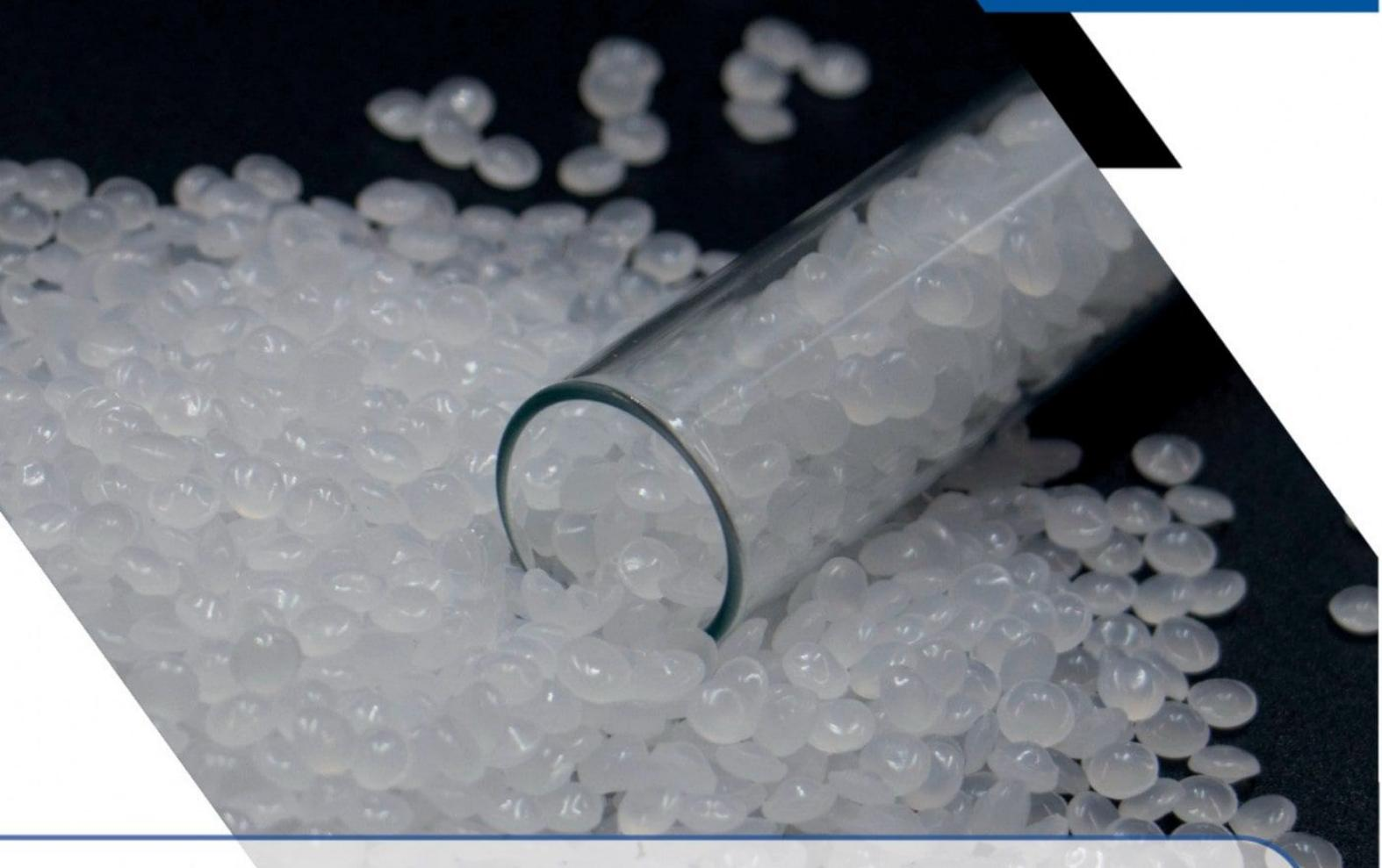
مستریج های آنتی اکسیدانت، یکی از مهمترین افزودنی های صنعت پلاستیک هستند که در فرایندهای تولیدی استفاده می شوند. پلاستیک ها معمولاً تخت تاثیر نور، اکسیژن و حرارت به سرعت دچار پیر شدن می شوند که منجر به افت استحکام، سفتی، انعطاف پذیری، تغییر رنگ، خراشیده شدن و کاهش شفافیت می شود. بنابراین، استفاده از مستریج آنتی اکسیدانت منجر به پایداری پلیمر در برابر عوامل اکسایش در فرآیند تولید، جلوگیری از تخریب و اکسید شدن پلیمر در دمای فرآیندی بالا، بهبود مقاومت محیطی پلیمر و بهبود خواص مواد بازیافتی می گردد.
